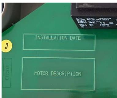
Un emplacement est réservé dans le coffret pour noter la date d'installation, ainsi qu'un second pour coller l'étiquette moteur amovible.
